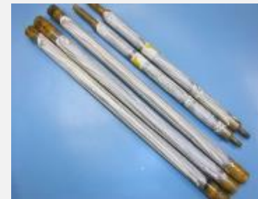
Roztwór CaCl 2 720 g/l 30g koliny wymieszane w roztworze CaCl 2 Warunki badania: 60 °C, wilgotność 3 – 8%, 96 h
