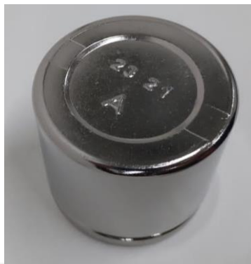
Tłok (Ms) pokryty w Nichem ® One MP
