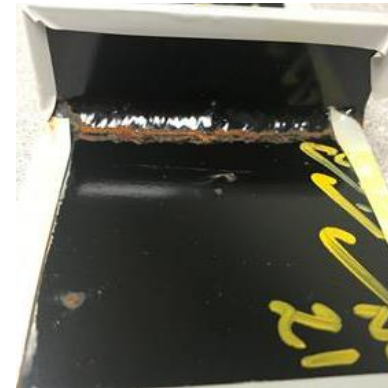
Po usunięciu zgorzeliny (840 godz.)
