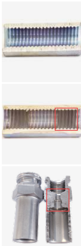
Bild 1: Zinni AL 450 zeigt eine homogene Schichtdickenverteilung und Tiefenstreuung selbst in den LCD-Bereichen in einer Hülse (Querschnitt).
