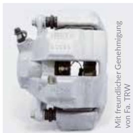
Montierter Bremssattel nach 1.000 h NSS (ISO 9227)
