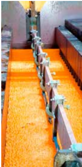
Bild 1: Fumalock Schaumdecke auf der Badoberfläche eines Verchromungsbades
